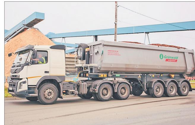
Один из них – трёхосный прицеп фирмы Grunwald. Он предназначен для перевозки сыпучих материалов и впечатляет техническими характеристиками: грузоподъёмность более 30 тонн, объём кузова – 34 кубических метра.
